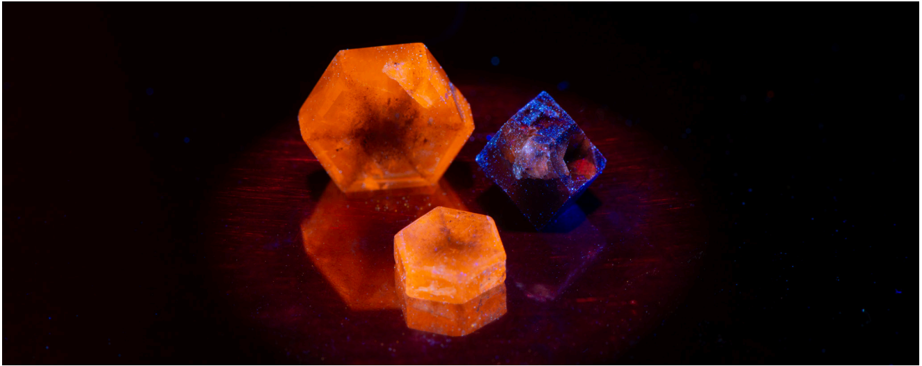
Figure 3 : Luminescence des grenats trapiches sous UVL, 365 nm, montrant une couleur orange relativement intense, en particulier pour les tranches de grenats taillées.
